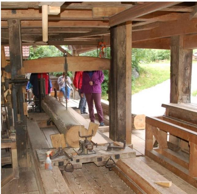
Die Welle des Wasserrades treibt anschliessend die verschiedenen Anlagen über Transmissionen an. Durch die geeignete Wahl der Durchmesser der Räder über die, die Riemen laufen wird die Sägegeschwindigkeit bestimmt.
