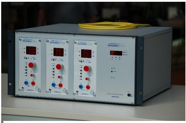
3-fach Netzgerät mit pA-Strommessung bei 500 V
